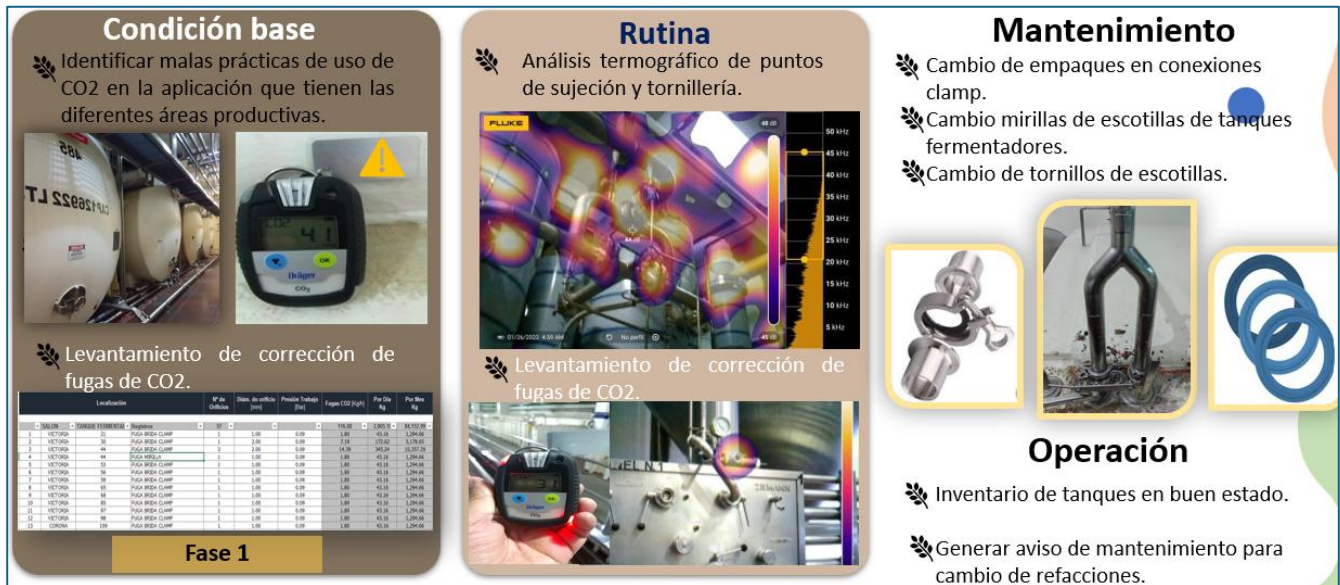
Figura 71. Seguimiento oportuno para controlar micro fugas de CO 2 el área de filtración de cerveza.
