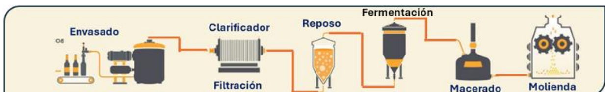
Figura 15. Diagrama de flujo para la elaboración de la cerveza.
