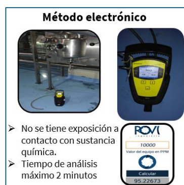
Figura 32. Aparato Haffman mide concentración de CO 2 en la cerveza.
