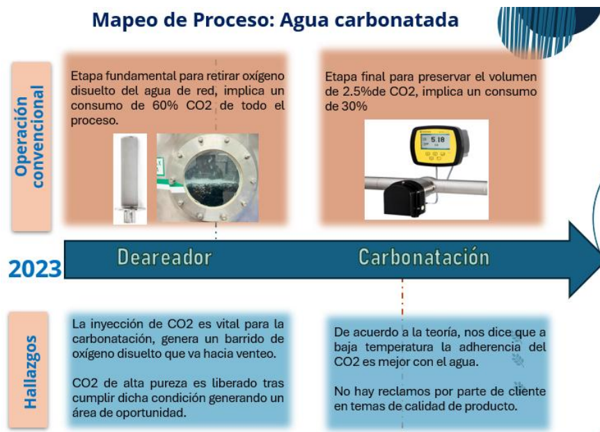
Figura 26. Actividades clave en la etapa de carbonatación del agua.
