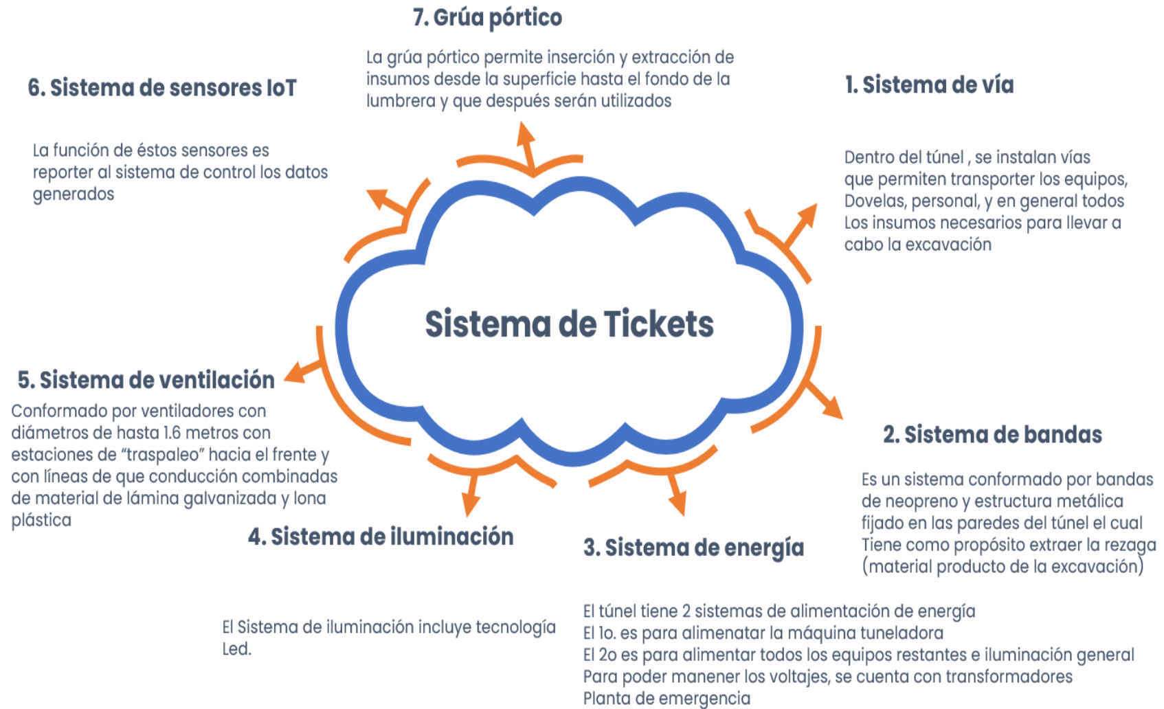
Figura 12. Diversidad de sistemas presentes en la construcción de un túnel.
