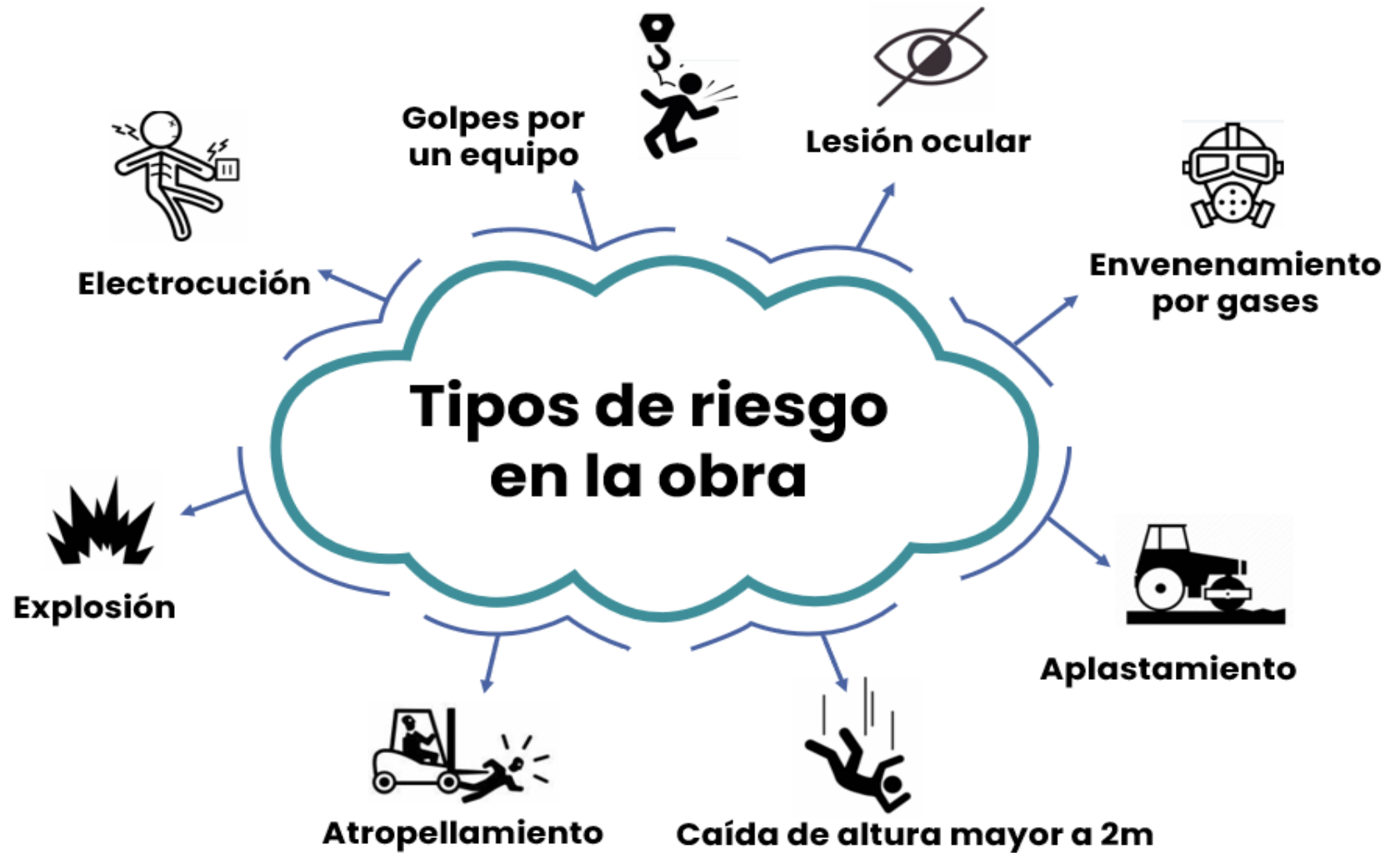
Figura 2. Accidentes más comunes en la construcción de un túnel
