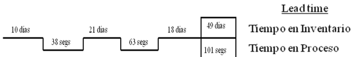
Fig. 34 Esquema ilustrativo para elaborar el mapa de la cadena de valor. ELABORACION: Personal.
