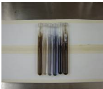
Figura 21. Determinación de la relación oxalato hierro para el fototratamiento de fenol. De izquierda a derecha se tienen los experimentos 6-1-2-3-4-5 descritos en la tabla 17.
