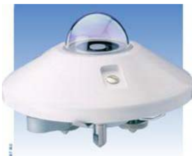
Figura 22. Piranómetro Kipp Zonen
