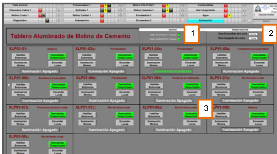
Figura 3.7.2 Detalles del Alumbrado del Molino de Cemento en POLCID.
