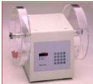
Imagen 2.10.3. Imagen de un equipo de resistencia al desgaste basado en el método de cilindro giratorio para el estudio de la pérdida de peso de un comprimido.
