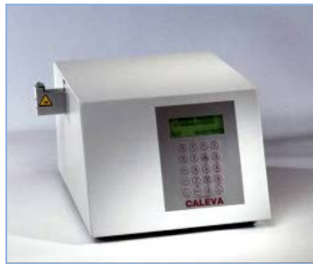
Imagen 2.10.4. Imagen de un equipo de resistencia a la fractura basado en el método de placas para el estudio de la fuerza de fractura de un comprimido.
