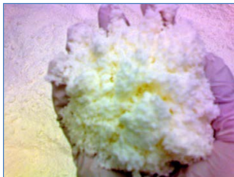
Granulado en interior de un contenedor de mezclado previo a su compresión.
