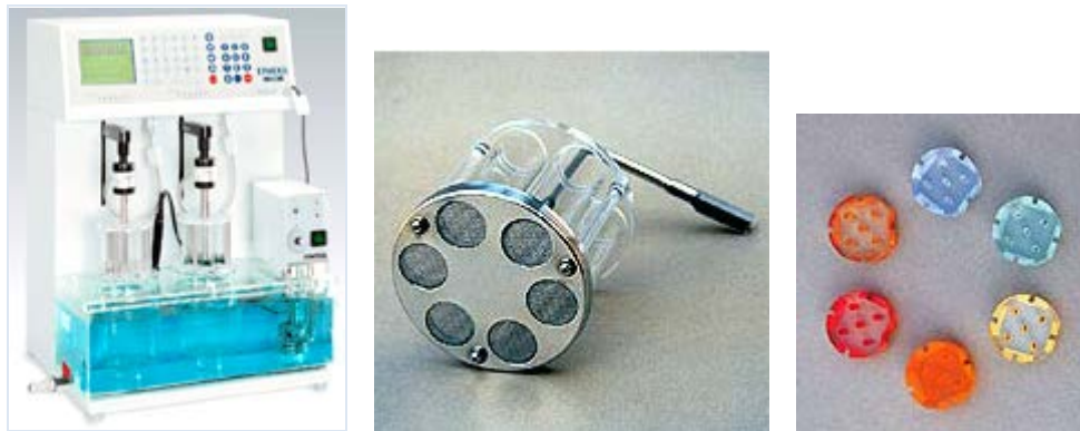
Imagen 2.10.1. Imagen de un equipo de disgregación para el estudio del tiempo de disgregación de un comprimido.
