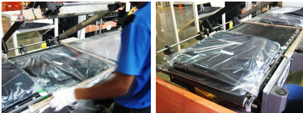
Figura No. 4.14 Máquina embolsadora de tapetes, operación 70.
