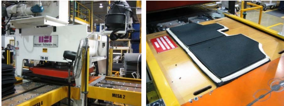
Figura No. 4.10 Máquina troqueladora tapetes, operación 30.
