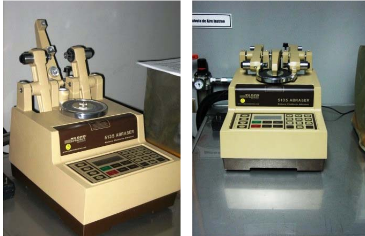
Figura No. 4.4 Máquina Taber para prueba de abrasión para tapetes.
