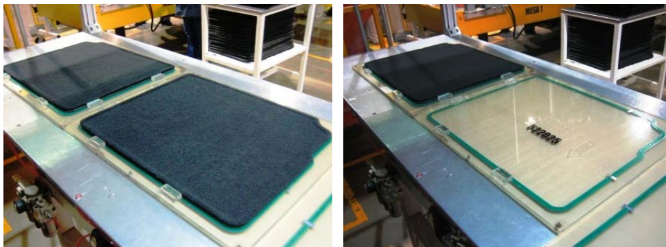
Figura No. 4.13 Dispositivo de verificación dimensional para tapetes, operación 60.
