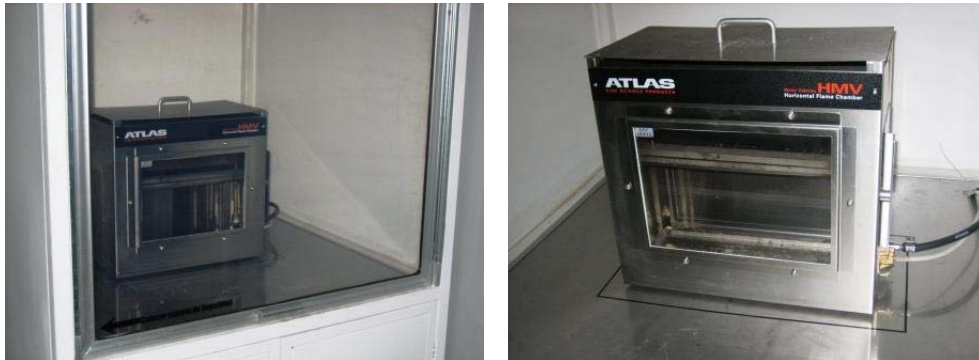
Figura No. 4.5 Cámara de flamabilidad para prueba de tapetes.
