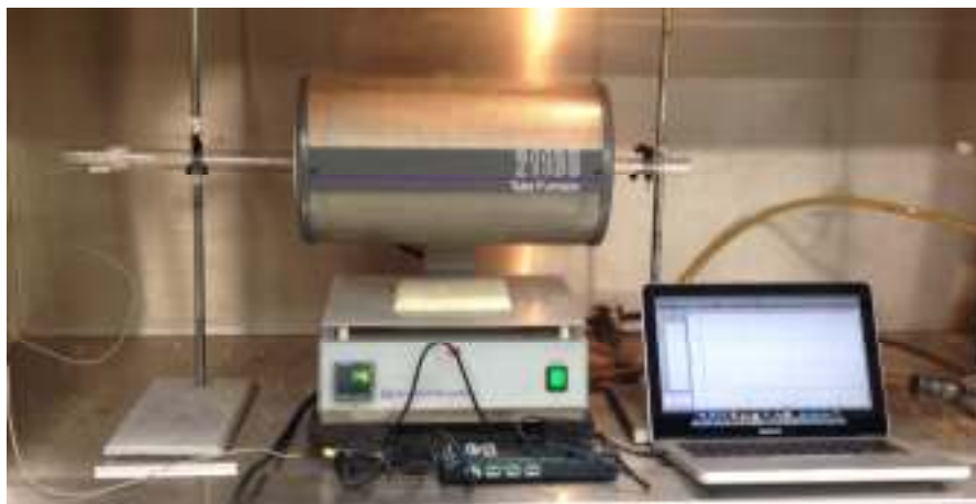
Figura A1. Sistema experimental para verificación de perfiles de temperatura
