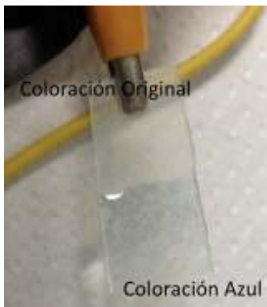
Figura 29. Respuesta electrocrómica del depósito de \text{MoO}_3 obtenido con un flujo de \text{O}_2 de 200 \text{ cm}^3/\text{min} , T = 400^\circ\text{C} , P = 17 \text{ Torr} y 80 mg de precursor ( \text{Mo}(\text{CO})_6 ).
