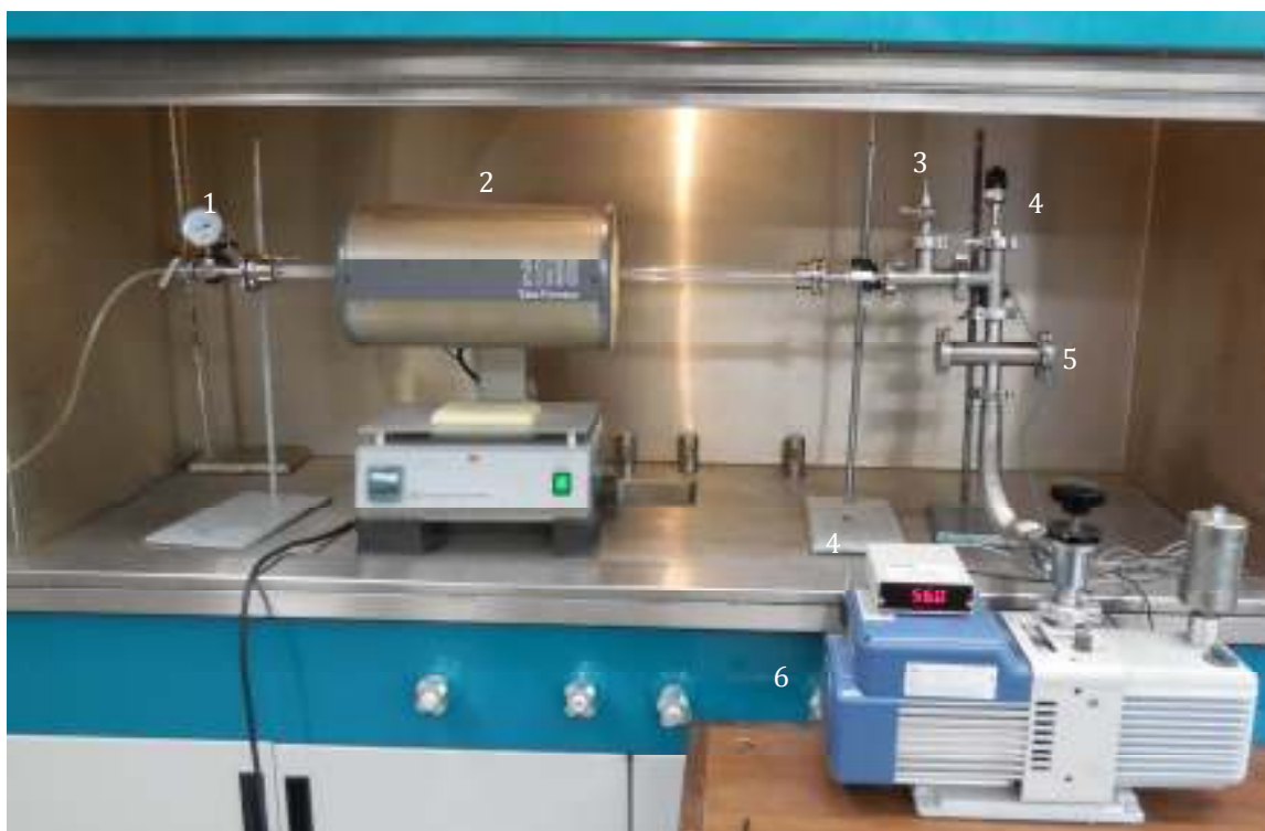
Figura 5. Sistema CVD de Baja Presión: 1) entrada de gases, 2) horno tubular con tubo de cuarzo de 2.4 cm de diámetro (reactor), 3) vacuómetro, 4) medidor de presión en el sistema, 5) filtro para polvos fabricado de bronce, 20 micrones y 6) bomba de vacío.
