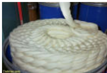
Figura 3.5. Fabricación de la mecha de algodón, parte del proceso de hilatura convencional.
