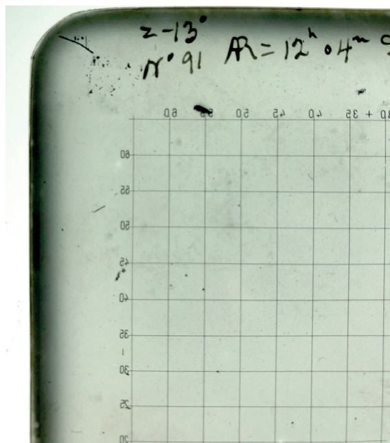
Figura 8. Flare y aberraciones en zonas marginales de la placa. Zona -13^\circ N° 91. Observatorio Astronómico Nacional de Tacubaya, Colección Instituto de Astronomía, UNAM.
