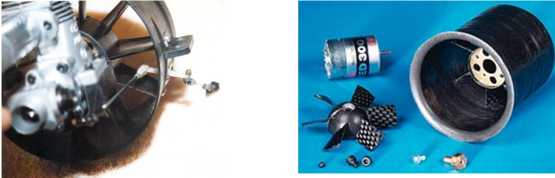
Fig.1.2 Un “Ducted Fan” con motor de pistón y uno con motor eléctrico
