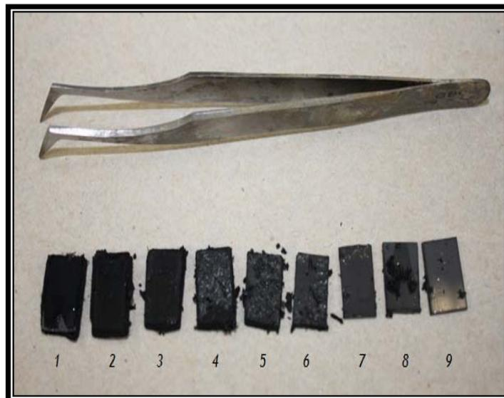
Figura A2. Crecimiento de nanotubos de carbono en cuarzo. Los números del 2 al 6 son los que presentan mayor cantidad de nanotubos debido a que se encontraban justo en medio del tubo.
