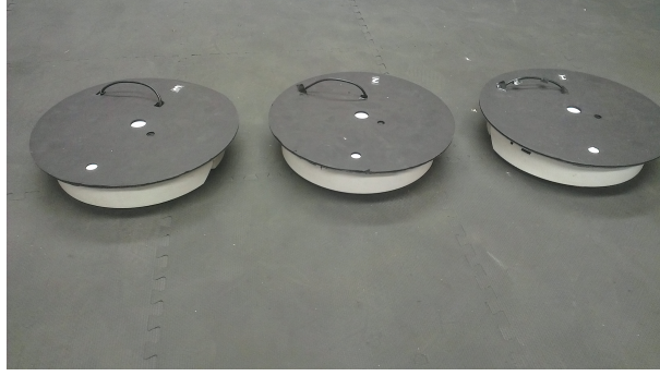
Figura 5.1: Plataforma de experimentos con 3 Irobot Create
