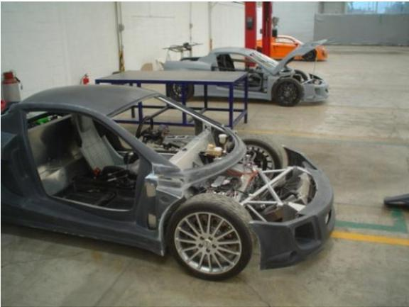
El nuevo local de 2,400m<sup>2</sup> estaba distribuido en un 50% para la planta de producción de los MXT, previendo la instalación de una caseta de pintura adecuada, una cortadora de láser requerida por el volumen de piezas procesadas con esta tecnología y áreas propicias para los procesos de fusión y vacío necesarios por los materiales compuestos como la fibra de vidrio y carbón.
