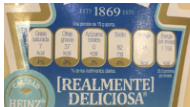
Imagen 11. Mayonesa Heinz. La tipografía en las GDA se ve borrosa, debido a que el calado y la tinta no coinciden en el mismo lugar. Fotografía tomada por: Latapí, Y.
