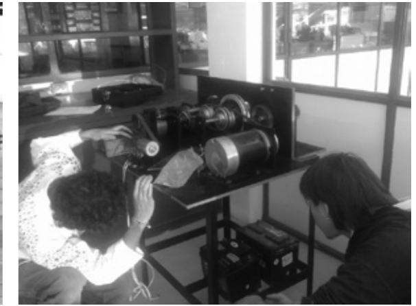
Banco de pruebas del tren de potencia híbrido.
