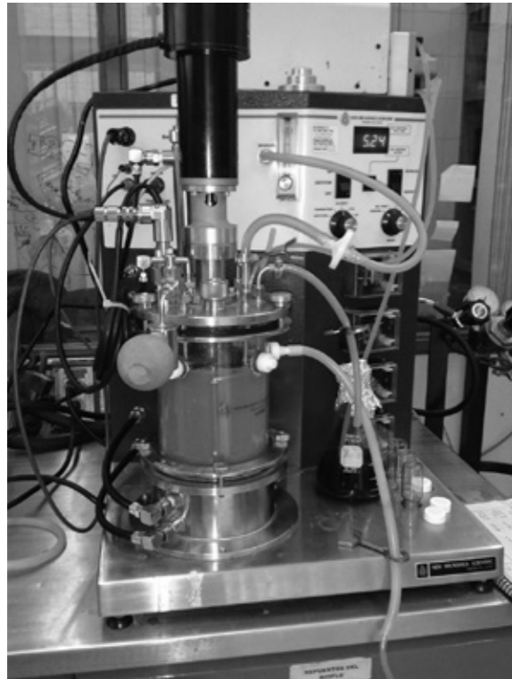
Producción de biosurfactantes en un fermentador instrumentado de 3 L.
