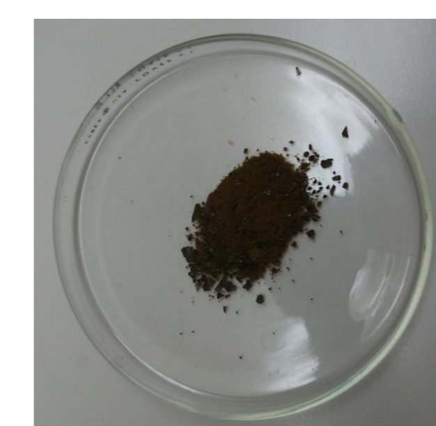
Fig. 3. Recuperación de subproductos(lignina)
