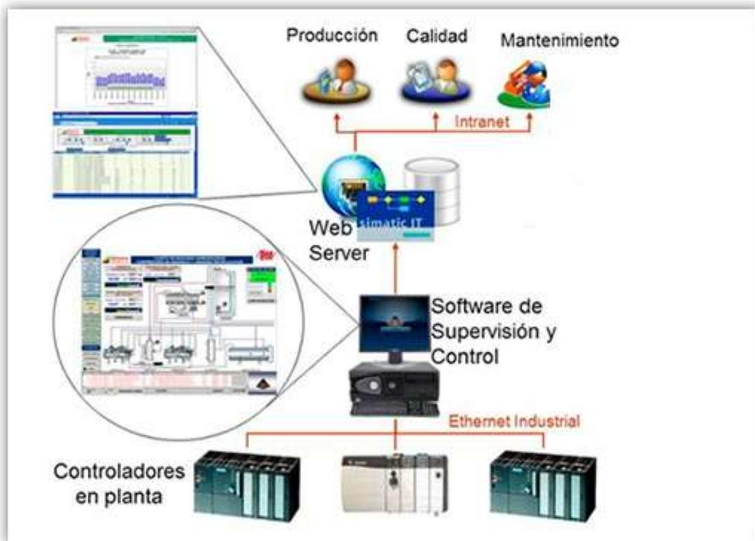
Imagen 31. Integración de Software a procesos de automatización
