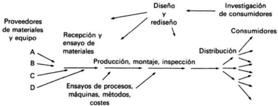
Imagen 4: La producción vista como un sistema. La calidad abarca toda la línea de producción, desde los materiales en recepción, hasta el consumidor<sup>6</sup>
