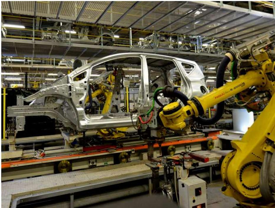
Imagen 18. Proceso automatizado para la producción de automóviles<sup>28</sup>
